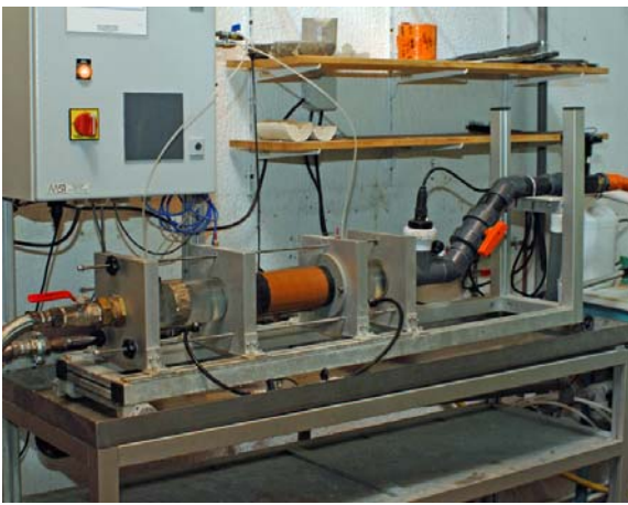
FIGURE 2 : L'ESSAI D'ÉROSION DE CONDUIT « HET » DE IRSTEA UTILISÉ PAR GEOPHYCONSULT
