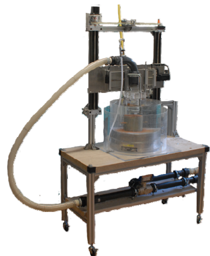
FIGURE 5: L'ESSAI D'ÉROSION PAR JET DE GEOPHYCONSULT
