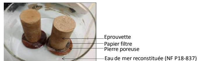
FIGURE 4. DISPOSITIF EXPÉRIMENTAL POUR L'HUMIDIFICATION PAR MONTÉE CAPILLAIRE
