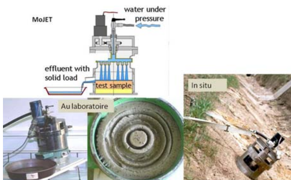
FIGURE 6: DISPOSITIF MOJET POUR L'ÉVALUATION DE LA SENSIBILITÉ À L'ÉROSION EXTERNE
