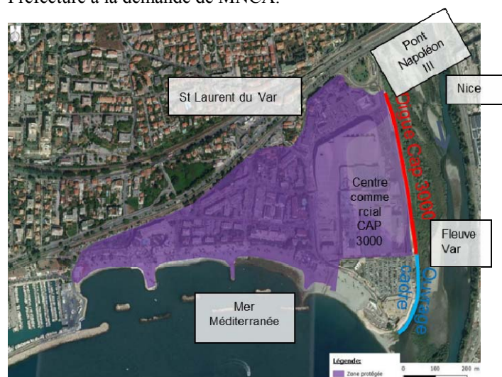
FIGURE 12 : SYSTEME D'ENDIGUEMENT CAP 3000 ET ZONE PROTEGEE
